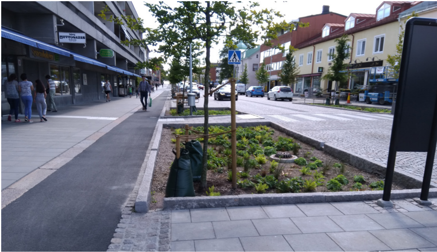
referentie infiltrerende plantvakken met overstort
